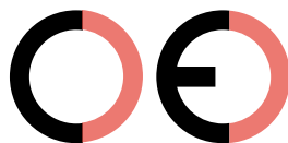
Marcatura CE contraffatta (troppo distante)
